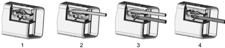
Abbildung 7-2: Leiteranschluss an der schraubenlosen Klemme
