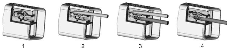
Abbildung 7-2: Raccordement du conducteur à la borne sans vis
