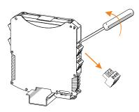
Colocar a chave de parafusos atrás do borne.
