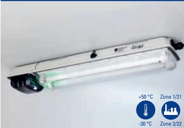
Diese Leuchte dient zur Sicherheitsbeleuchtung. Sie ist leicht und wartungsarm. Die Batterie im externen Gehäuse stellt die Notlichtfunktion über 1,5 oder 3 Stunden sicher. Eine interne Schutzbeschaltung gewährt volle Redundanz bei Lampenausfall. Beim Öffnen des Zentralverschlusses wird die Leuchte standardmäßig allpolig abgeschaltet.
