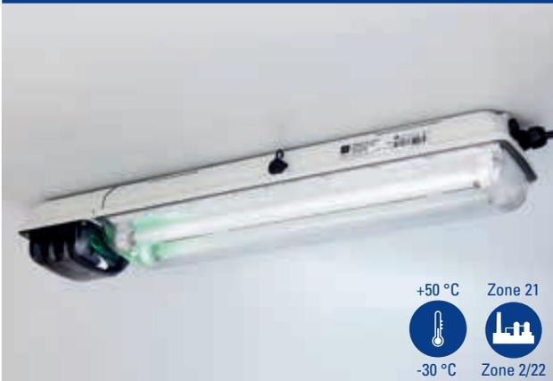
Die EXLUX der Reihe 6409 dient zur Sicherheitsbeleuchtung. Sie ist leicht und wartungsarm. Eine externe Batterie versorgt das Notlicht 1,5 oder 3 Stunden. Bei defekter Lampe wird auf die intakte Lampe umgeschaltet und der Batteriekreis beim Öffnen von Leuchte oder Batteriekasten abgeschaltet. Das stabile Kunststoffgehäuse lässt sich über den praktischen Zentralverschluss leicht öffnen.
