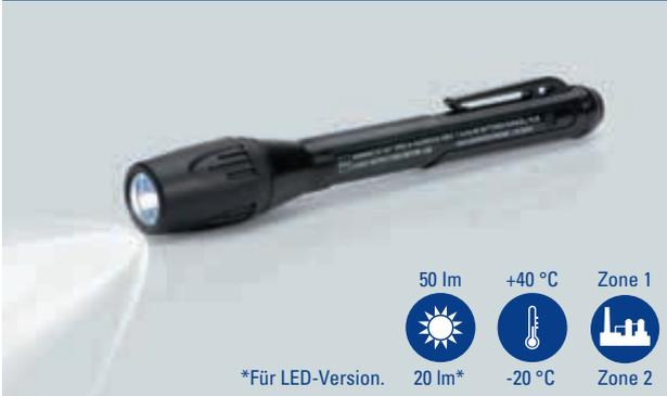
Die batteriebetriebene Handleuchte 6141/61 passt in jede Tasche und ist bei Bedarf immer zur Hand. Sie lässt sich über einen Drucktaster einhändig ein- und ausschalten. Die Handleuchte erfüllt den Schutzgrad IP68 und ist nach ATEX und IECEx für explosionsgefährdete Bereiche zugelassen.
