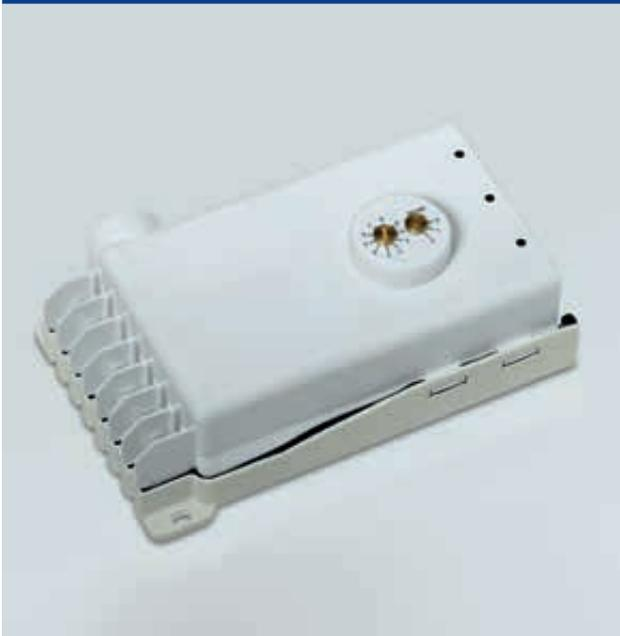
R. STAHL bietet nahezu alle Leuchten mit einem Adressbaustein an. Dieser stellt die Kommunikationsschnittstelle zur Zentralbatterieanlage dar und ermöglicht die einsatzspezifische Steuerung der Leuchte entsprechend den Anforderungen an das Sicherheitskonzept der Anlage. Das Adressmodul ermöglicht die Einstellung der individuellen Adresse für jede mit einem Adressmodul ausgestattete Leuchte.
