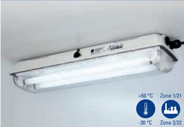
Die Leuchte eignet sich sowohl für die Normalbeleuchtung als auch für die Sicherheitsbeleuchtung in fast jeder Anlage. Mit dem Zubehör kann sie einfach an der Wand, Decke, am Mastansatz oder hängend montiert werden. Der praktische Zentralverschluss enthält einen Sicherheitsschalter zur allpoligen Abschaltung beim Öffnen des Kunststoffgehäuses.
