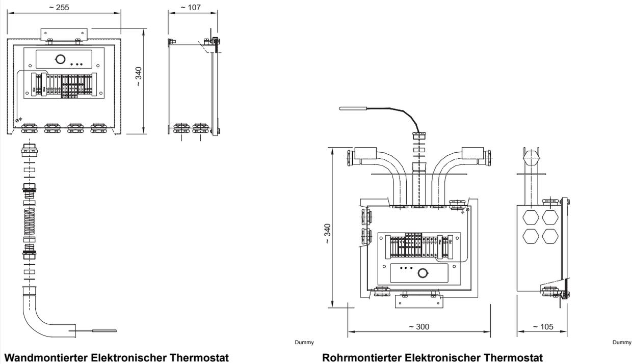
Wandmontierter Elektronischer Thermostat
