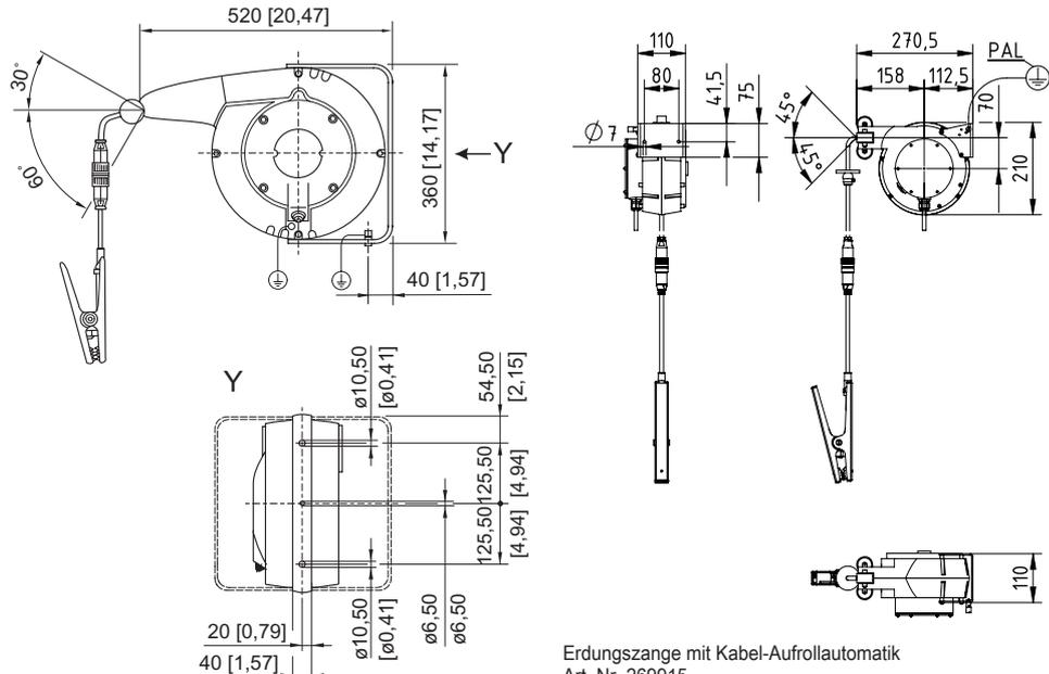
Erdungszange mit Kabel-Aufrollautomatik
