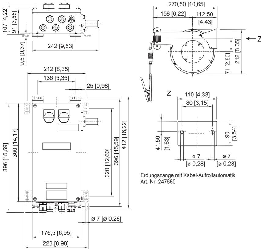
Erdungszange mit Kabel-Aufrollautomatik
