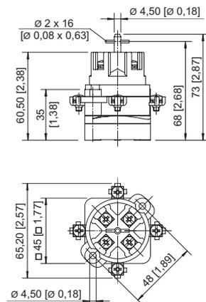
8008/2-1 Steuerschalter 3- oder 4-polig
