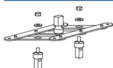
zum gleichzeitigen Betätigen von 2 miteinander kombinierten Last- und Motorschaltern
