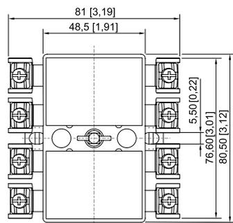
Last- und Motorschalter Reihe 8006/4, 1-polig und 2-polig
