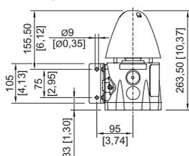
GRP Akustisches Signal Reihe YA6S mit L-Bügel
