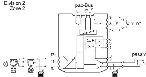
Feldgerät                      ISpac Trennstufe                      SPS / PLS
