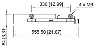
Projecteur avec dissipateur thermique et œillets
