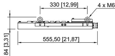
Projecteur sans dissipateur thermique, avec œillets
