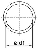
d1 = Diamètre intérieur    d2 = Diamètre extérieur
