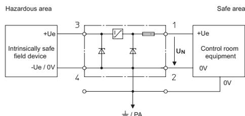
Barrières Zener de sécurité intrinsèque un canal avec limitation électronique de courant pour potentiel positif avec limitation de tension
