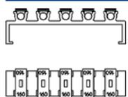
Le porte-fusible se clipse sur le côté de la barrière de sécurité et peut héberger jusqu'à 5 pré-fusibles (remplacement).
