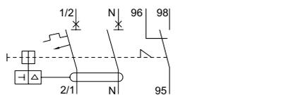
1 pôle + N, contact de signal d'erreur 1 contact à deux directions
