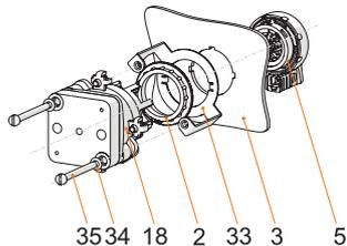
Montage en encastrement frontal avec commutateur de commande série 8008
