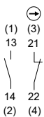
Esquema de circuito 8003/143 Contacto NC de apertura forzada/contacto NA Números entre paréntesis correspondientes a la identificación del cable
