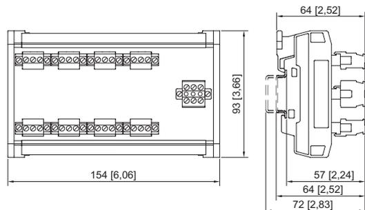
Acoplamiento de dispositivo de campo, 8 pistas, sin envoltorio
