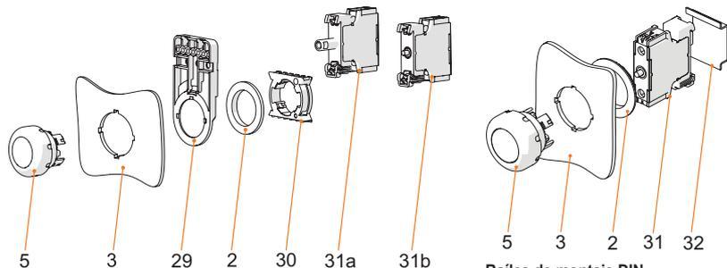
Montaje frontal con indicador de la serie 8010/6 y elemento de contacto de la serie 8082/3
