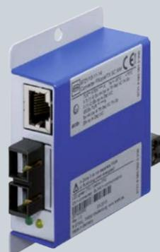
Der Medienkonverter Reihe 9721 setzt elektrische in optisch inhärent sichere „op is“-Signale um, und ermöglicht so Installations- und Wartungsarbeiten am Lichtwellenleiter im Betrieb in Zone 0, 1 und 2 (hot-swap, hot-work). Er eignet sich besonders für das Ethernet Remote I/O-System IS1+.
