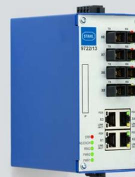
Die gemanagten 100 Mbit/s-Switches Reihe 9722 sind speziell für den Einsatz in PROFINET-Netzwerken konzipiert. Sie verfügen über eine Ringfunktionalität auf Basis des Media Redundancy Protocol. Die 4 LWL-Ports sind in der Zündschutzart „op is“ ausgeführt, so dass Geräte in Zone 0, 1 und 2 einfach gewartet werden können (hot-swap, hot plug).
