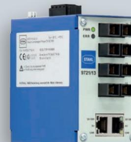
Der Switch 9721 dient zur Vernetzung von elektrischen mit optischen 100 Mbit/s-Ethernet-Netzwerken. Die 4 LWL-Ports sind zum Betrieb in explosionsgefährdeten Bereichen in der Zündschutzart „op is“ ausgeführt. Hiermit sind konventionelle LWL-Kabel auch im explosionsgefährdeten Bereich einsetzbar und dürfen im Betrieb gesteckt und getrennt werden (hot-swap).
