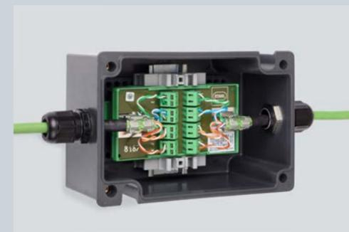
Die Ethernet-Klemme 8187 dient zum Anschluss von CAT5/6/7-Kabeln mit Übertragungsraten bis 1 GBit/s in explosionsgefährdeten Bereichen der Zone 1 und ersetzt damit die nichtzulässigen industriellen Steckverbinder.
