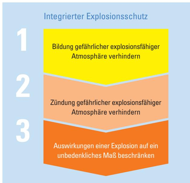
Bild 3: Explosionsschutzmaßnahmen
