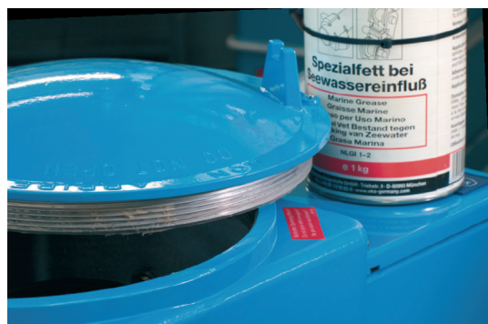
Bild 9: Verwendung von korrosionshemmenden Fett
